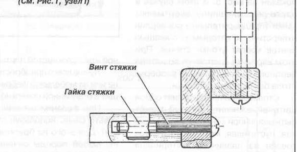
сверлят гнезда и отверстия в торцах. Глубина гнезд под шканты должна быть 20 мм, а глубина отверстия под винт – на 10 мм больше длины винта.
