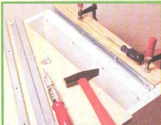
При креплении направляющей шины в качестве ограничителя используют обычную рейку.
