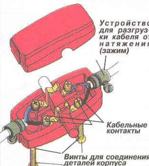
Промежуточный выключатель для двухжильного кабеля. В выключателях других моделей устройство для разгрузки кабеля от натяжения может выглядеть по-другому.
