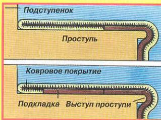
При подвороте верхней части ковра используют подкладку, выравнивающую его поверхность
