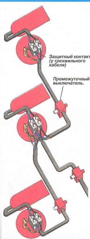
Последовательность соединения ламп. При необходимости в питающие провода можно встроить промежуточные выключатели.
