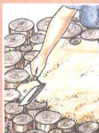
После заполнения шов песком вымыщенную поверхность утрамбовывают виброплитой. Ни в коем случае не следует укреплять дорожку по краям, иначе она выпучится. Вместо этого можно отсыпать по краям полосами измельченную кору и уплотнить.
