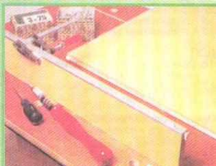
**Отверстия в уголковых профилях тщательно раззенковывают под потайные головки шурупов.**
