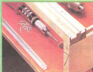
**В траверсе из твердой древесины рекомендуется предварительно просверлить отверстия под шурупы.**
