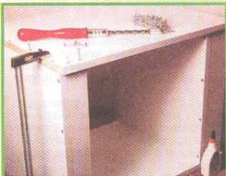
Детали выдвижного шкафа соединяют между собой на клею и шурупах.
