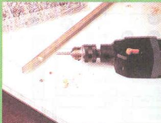
**Боковые стенки соединяют с нижней горизонтальной плитой на шкантах с kleem. Точную разметку отверстий под шканты обеспечивает самодельный шаблон.**
